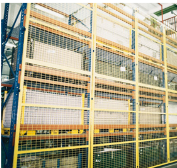
Panneaux grillagés sur les faces arrières des travées en bordure d'allée de circulation.
