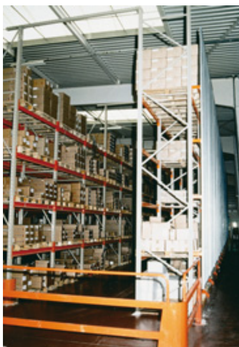
Panneaux grillagés sur les faces arrières des travées en bordure d'allée de circulation.
