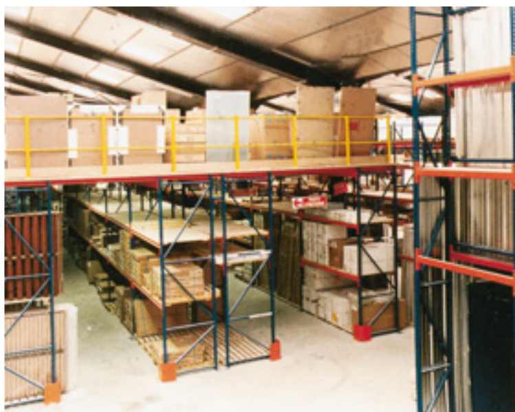
Plate-forme de stockage.
